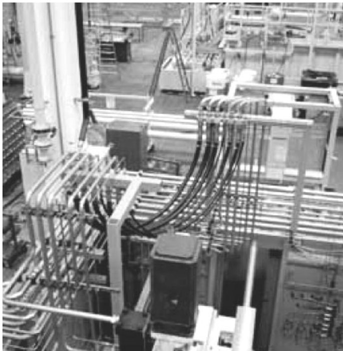
Trazado de líneas en una máquina de grandes dimensiones.
